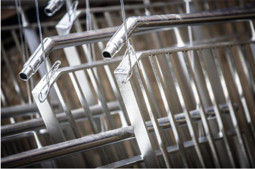
BU: Für die Verzinkung werden die Werkstücke an Traversen gehängt (Foto), in Gestelle oder Körbe verpackt.
