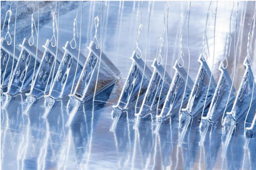
BU: Werkstücke in der 450 Grad Celsius heißen Zinkschmelze. Hier verweilen die Bauteile so lange, bis sie die Zinkbadtemperatur erreicht haben und sich eine Eisen-Zink-Legierungsschicht von durchschnittlich 80µm ausbildet
