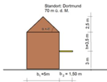
Um den oben aufgezeigten Rechenaufwand zu minimieren wird, auf der sicheren Seite liegend, der Formbeiwert an der aufgehenden Wand mit  $\mu_2 = 2,0$  angesetzt.
