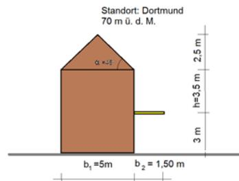
Das charakteristische Eigengewicht des Vordaches sei  $g_k = 0,50 \text{ kN/m}^2$  Dachfläche.
