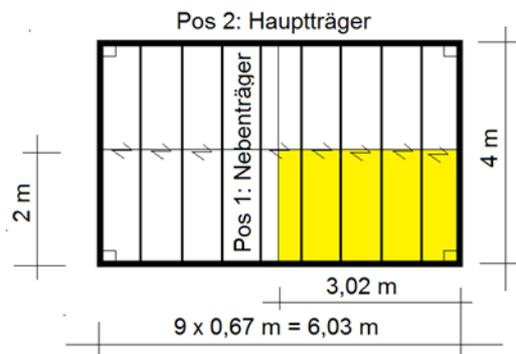
Jede der vier Eckstützen hat ein Viertel der Dachfläche zu tragen. Die Einflussfläche beträgt  $A = 2,00 \text{ m} \cdot 3,02 \text{ m} = 6,04 \text{ m}^2$ .
