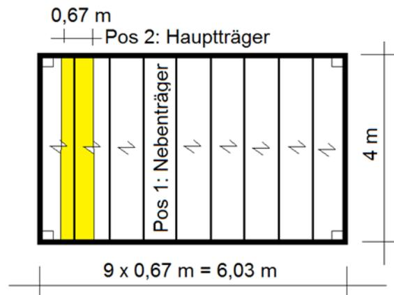
Bei einem gleichmäßigen Abstand der Nebenträger von 0,67 m hat jeder Nebenträger auch die Belastung aus einer anteiligen Dachlänge von 0,67 m zu tragen. Die Einflussbreite beträgt  $e = 0,67 \text{ m}$ .
