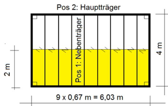
Jeder der beiden längslaufenden Hauptträger hat die Hälfte der Dachbreite von 4 m zu tragen. Die Einflussbreite beträgt  $e = 2,00 m$ .
