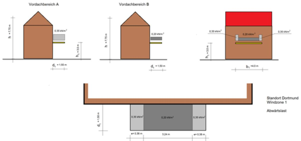
Anmerkung: Da bei dieser Geometrie des Vordaches die Länge Bereich A (0,38 m) gegenüber der Gesamtlänge des Vordaches von 4 m relativ klein ist, könnte es der Verfasser verantworten, die Windlast von 0,2 kN/m² auf der Gesamtfläche ansetzen, um doppelten Rechenaufwand bei den weiteren statischen Berechnungen zu sparen.
