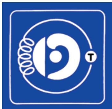
*Piktogramm für Induktionsanlage; „T“ steht für die Telefonspule genannte Induktionsspule*
